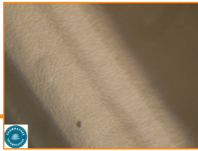
Schlauch vor Behandlung mit einer Überkonzentration von alkalischen Reinigungsmittel.
